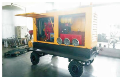
移动应急消防泵组
