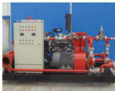
平衡式比例混合装置（一电一柴）
