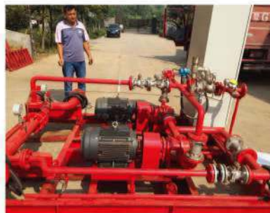
平衡式比例混合装置（双电）
