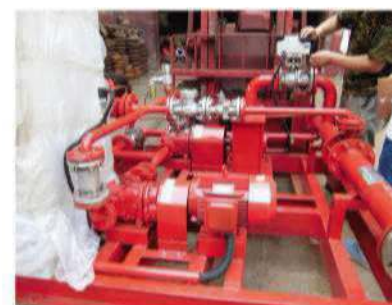
平衡式比例混合装置（一电一水）
